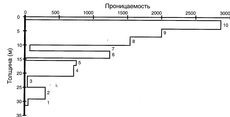
Свойства пласта-коллектора с возрастающей к подошве проницаемостью
